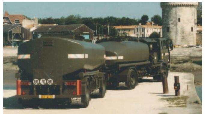
Porteur 12 m 3 & remorque 19 m 3 aérotransportables, type TOE
